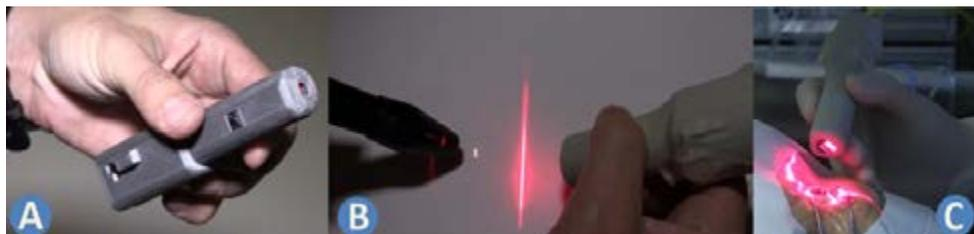
Foto 1: A) Prototipo impreso en 3D de láser. B) Comparación entre lámpara de hendidura intraquirúrgica (izquierda) y el láser (derecha). C) Modo de uso del láser.
